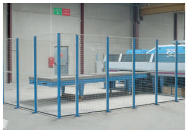
*Mise en place autour d'une poinçonneuse pour une meilleure organisation et une protection du poste de travail.*
